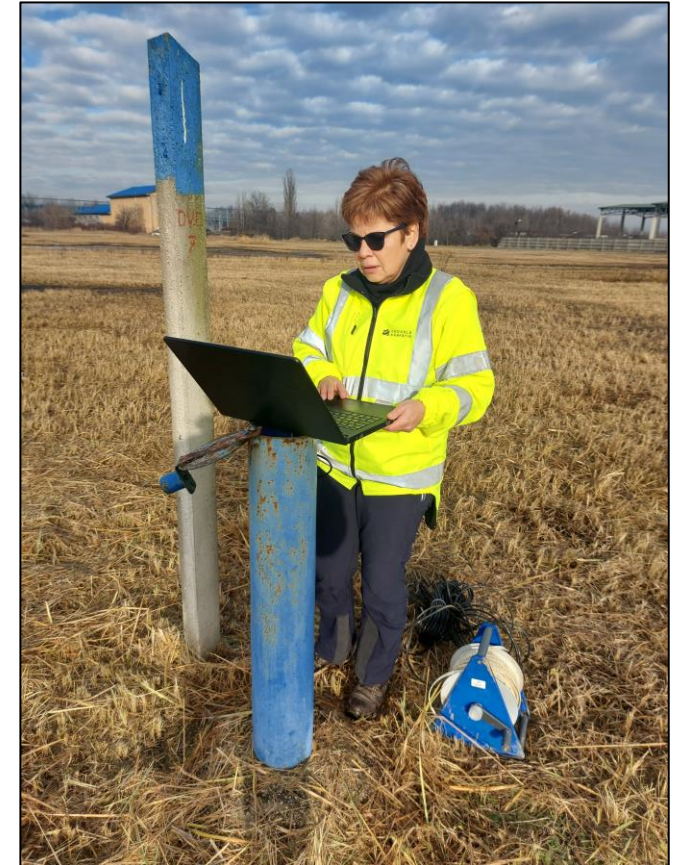
Vízszintregisztrálás egy Kazincbarcika környéki monitoring kútban
